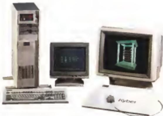
GS-2000 è una stazione grafica professionale completa di unità centrale: processore 80286-12 Mhz, 1 Mb di RAM, Hard Disk da 20 Mb, monitor 12" b/n, monitor 20" colori 1024x768 n.i., scheda grafica LEONARD, tavola digitalizzatrice formato A3 con cursore.
